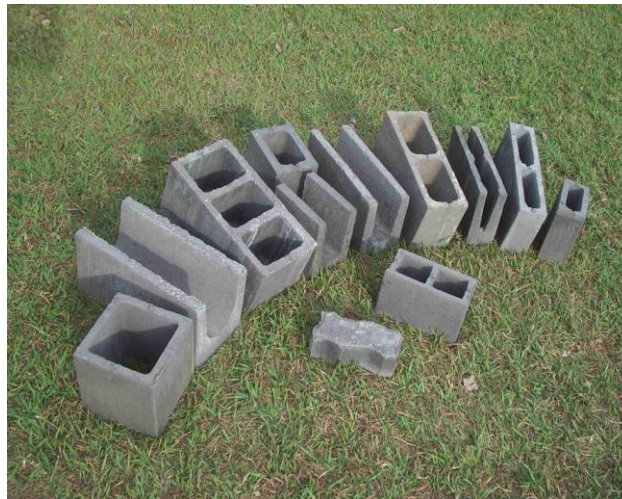
BLOCOS DE CONCRETO PRODUZIDOS COM AREIA DESCARTADA DE FUNDIÇÃO
