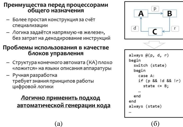
Рис. 2. а) Использование ASIC в качестве блоков управления. б) Трансляция автоматной схемы в описание на языке Verilog.
