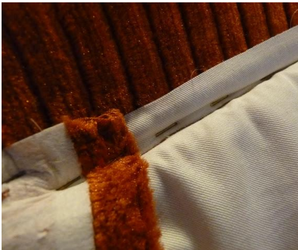
Grampos escondido no lado de baixo do flange.
