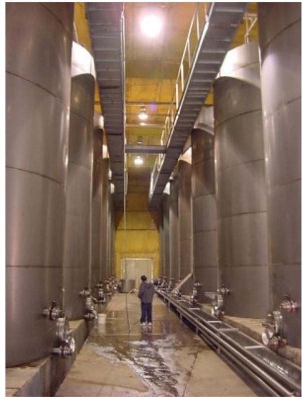
*Tanques de fermentación empleados para la producción de vinos de línea tradicional, con uva proveniente de viñedos de producción controlada.*
