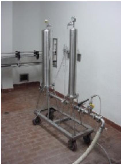
*Esta filtración, o microfiltración es el ultimo proceso de filtración que se lleva a cabo en un vino. Dependiendo de las características particulares de cada vino puede ser un proceso opcional.*
