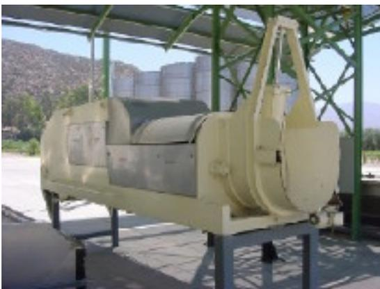
*Este tipo de prensas, a diferencia de las anteriores tiene la ventaja que trabaja en forma continua, es decir la alimentación, prensado y descarga ocurren simultáneamente en el tiempo, por lo que es mucho mas efectiva en el prensado de grandes cantidades de uva.*
