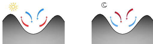
Fig. 2.04.- Corrientes convectivas en mesoclima de valle para situación de día y noche.
