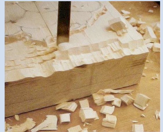
Desbastado de un bloque de madera.
