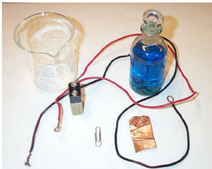
Figura 1. Materiales necesarios: pila, cables, objeto a recubrir, lámina de cobre, vaso de precipitados y disolución 1,0 M de sulfato de cobre, CuSO 4 .
