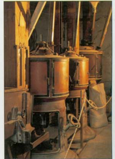
Vista interior de "Pila Vecia". No falta ni el más mínimo detalle de la última tecnología: estos cilindros descascarillan el arroz a presión y la cutícula de plata se va desprendiendo, mediante el frotado recíproco, de los granos de arroz.
