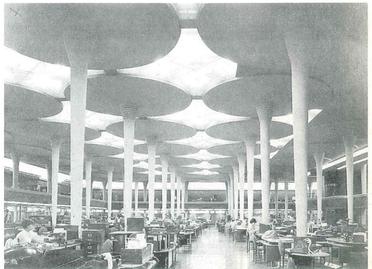
522. Frank Lloyd Wright, oficinas de la Johnson Wax, Racine, Wisconsin (1936-1939). En este célebre interior, el espacio está articulado por columnas con forma de hongo; una banda continua de luz corona los muros perimetrales.
