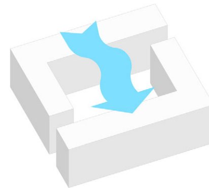
Img 2.2.B7. En un espacio de menores dimensiones, la velocidad del viento se atenúa. / Num espaço confinado de menores dimensões, a velocidade do vento sofre uma atenuação.
