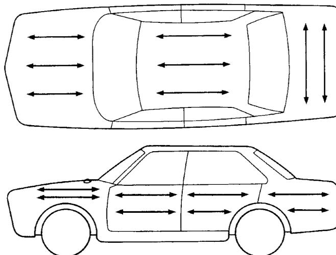
O lixador deve ser movimentado no sentido que a figura acima indica, da mesma forma que se faz com a pistola de pintura.
