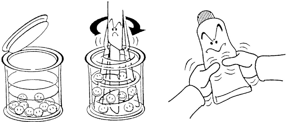
Retira-se a quantidade necessária da matéria principal sobre a tábua de mistura e faz-se a mistura na proporção de 100 de matéria principal por 2 de catalizador.
