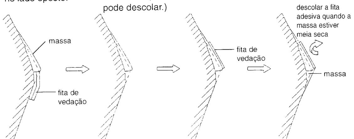
**Observação:** A camada grossa de massa aplicada numa só vez, pode causar trincamento na linha da prensa. Quando o craquelamento é muito profundo, aplicam-se várias demãos, secando a massa em cada demão.
