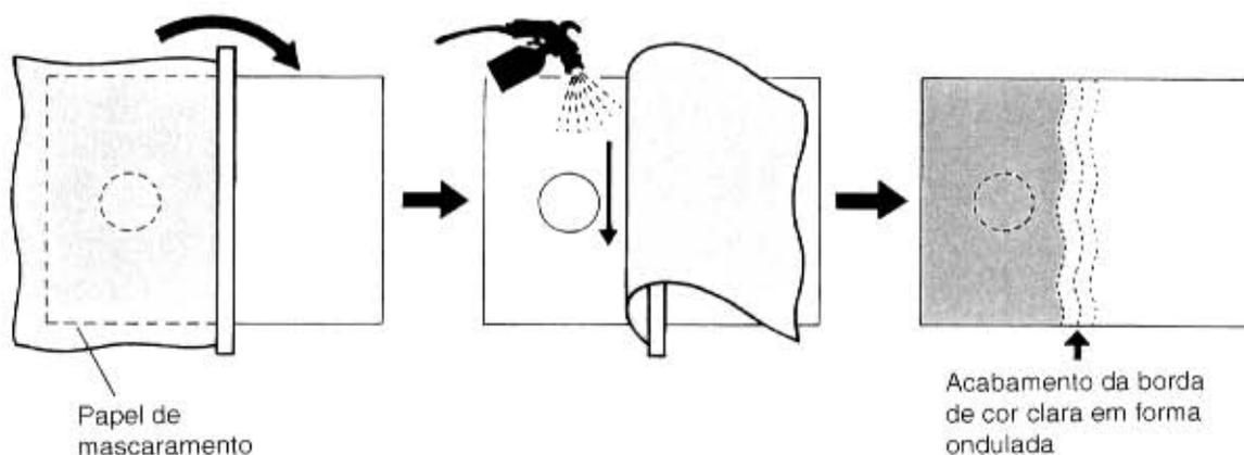
4. No caso de fazer o mascaramento da superfície vertical com espaço, deve-se pintar em forma vertical para não se acumular tinta pulverizada na parte enrugada do papel.
