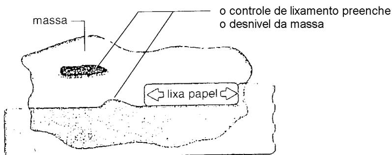
A camada de **controle** preenche o desnível da massa, e neste caso, a lixa deverá ser passada, ajustando o lixamento na parte mais baixa do desnível. (\*se o desnível ou o craquelamento forem muito profundos, a massa deverá ser novamente aplicada.)
