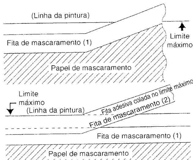
2-b Fixa-se a fita adesiva sobre a fita de mascaramento.
