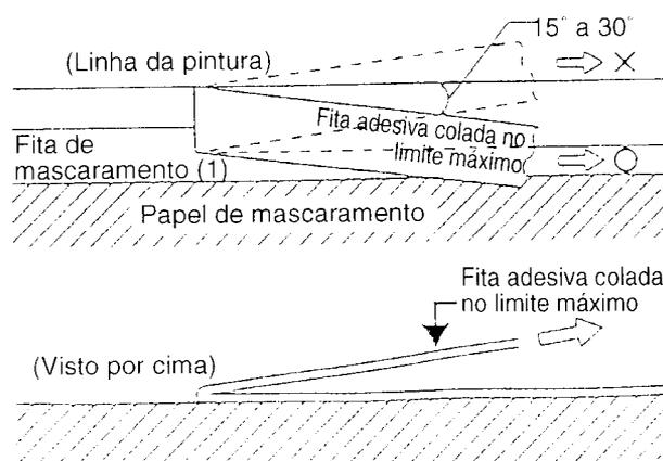
3. Para fazer a pintura em gradação entre a pintura antiga e a nova, levante o papel de mascaramento na forma indicada na ilustração, proporcionando um acabamento natural nas bordas.
