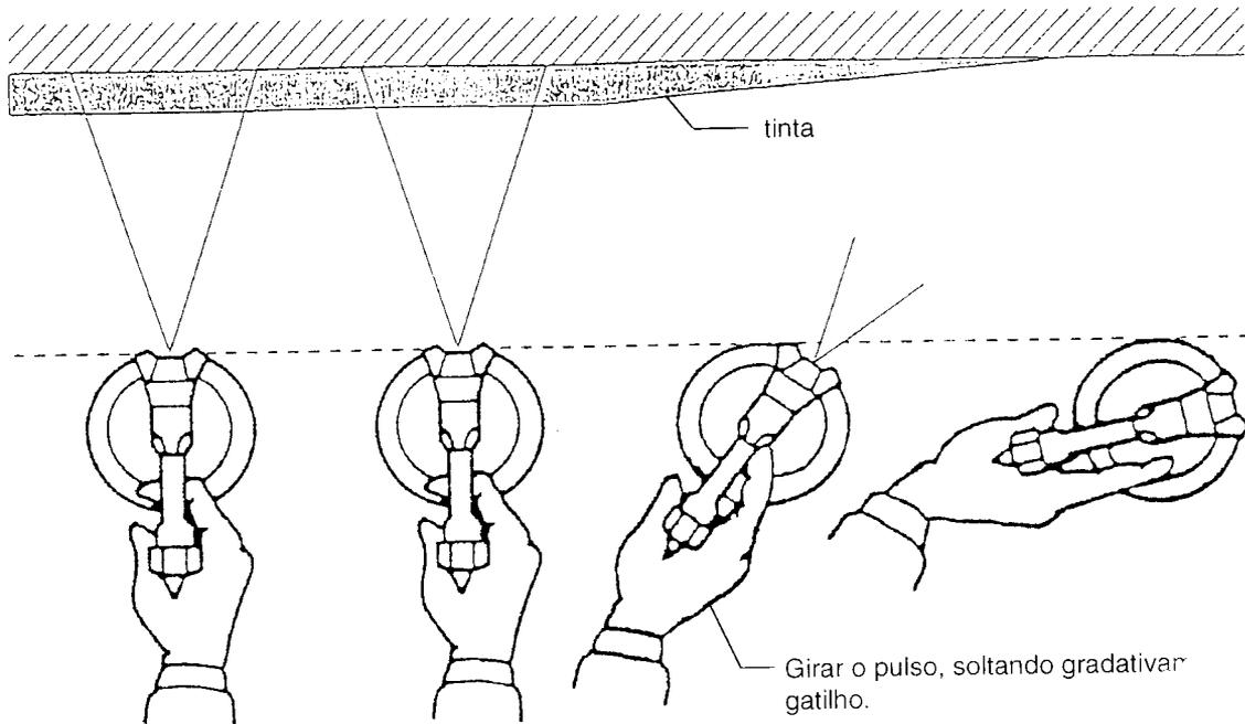
Essa operação permite guardar distância entre o objeto pintado e a pistola de pintura, no bordo da aplicação da tinta para remoção das manchas. Com isso, o bordo terá um acabamento plano e liso.
