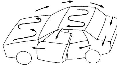
Na última parte 11, deve abrir a porta lateral e remover completamente as partículas de spray (É necessário o masking também na parte interna da porta).
