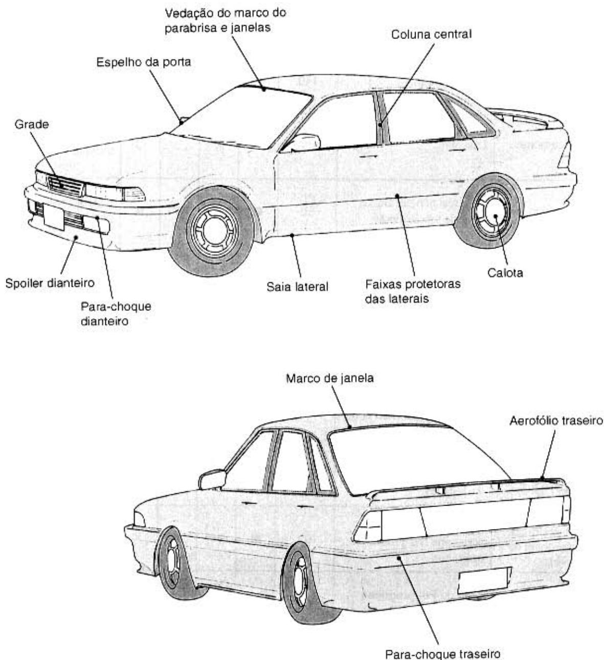
\* Além dos mencionados, existem carros que utilizam plásticos ou chapas finas de alumínio em partes da carroceria.
