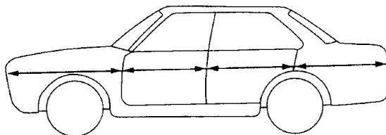
Para evitar que a camada engrosse apenas na parte da emenda, sobrepor as camadas aplicando o procedimento adotado na pintura da remoção das manchas.
