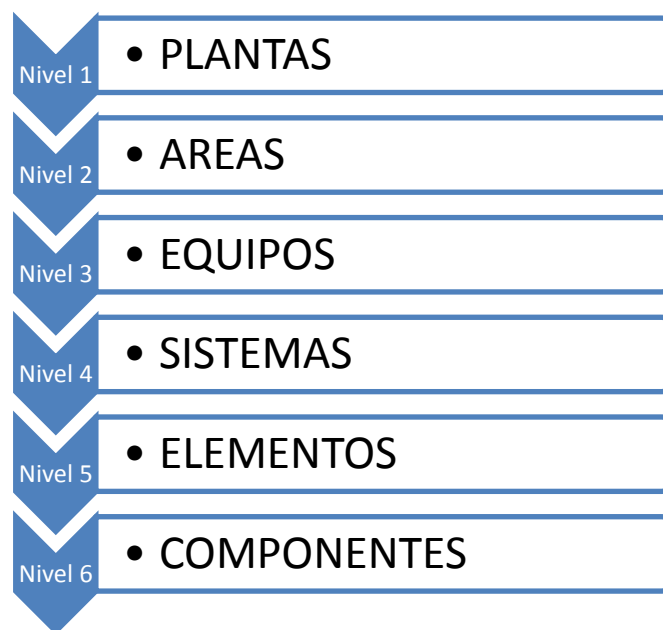
FIGURA 1.5. ESTRUCTURA DEL LISTADO DE EQUIPOS. FUENTE: ORGANIZACIÓN Y GESTIÓN INTEGRAL DE MANTENIMIENTO
