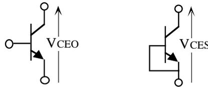
Figura 1.7. Definición de  $V_{CEO}$  y  $V_{CES}$ .
