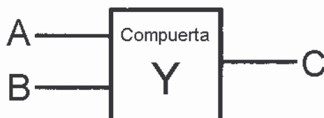
Figura 11. Representación simbólica de una compuerta Y usada en computadoras. Hay dos cables de entrada, A y B, y sólo uno de salida, C. Si se recibe una señal en ambos cables A y B, entonces se envía una señal de salida a C.
