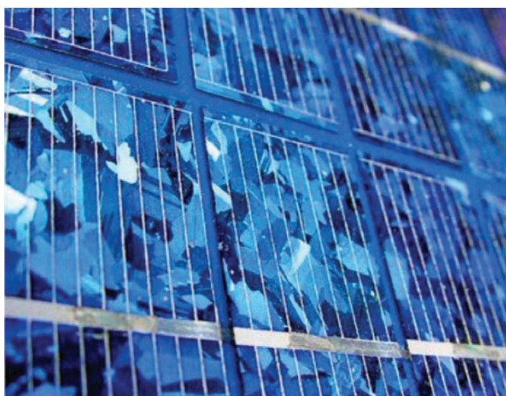
Figura 5. Acercamiento frontal de un panel fotovoltaico de silicio policristalino. Se puede observar las diferentes celdas del panel (veteadas en tonos de azul) y los contactos eléctricos frontales (líneas plateadas).
