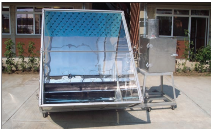
Figura 2. Refrigerador solar por absorción para la producción de hielo (Centro de Investigación en Energía, UNAM). Izquierda: concentrador solar parabólico compuesto; derecha: caja frigorífica.
