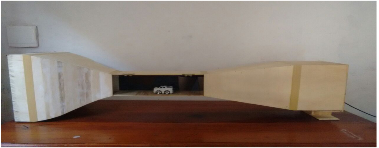
Figura 19 - Mini Túnel de Vento construído.
