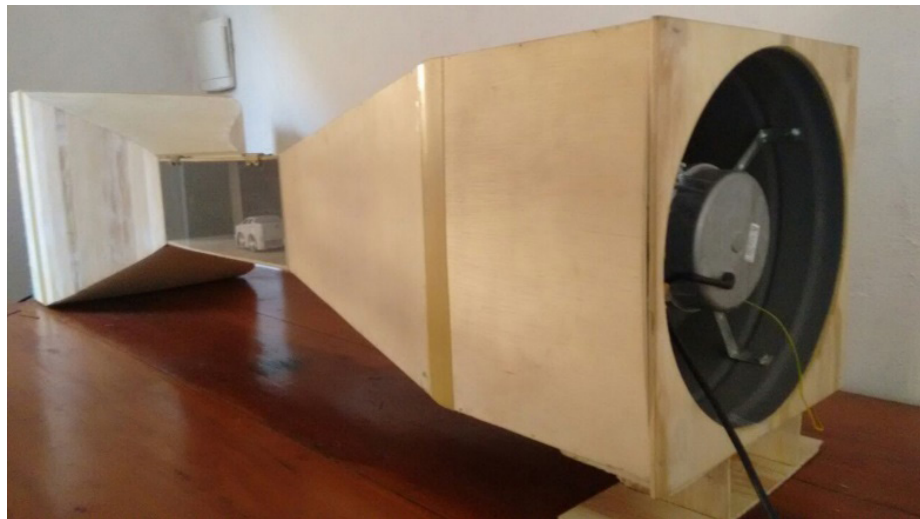
Figura 18 – Vedação na parte final do túnel de vento.
