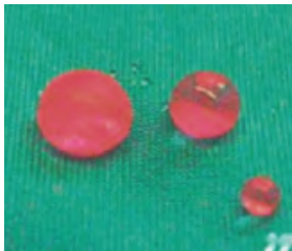
Figura 16. Las propiedades autolimpiadoras e hidrófobas de los textiles fabricados por el procedimiento nanotecnológico denominado Effet-Lotus® (© V.v.Arnim-ITV Denkendorf) 40 .
