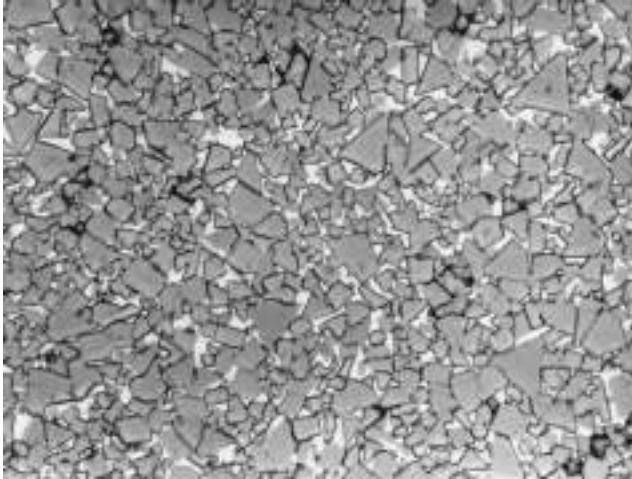
Figura 10.26 • Microestructura de un aglomerado de WC/Co; las partículas de WC están incorporadas a la matriz clara de Co (x 1.500).
