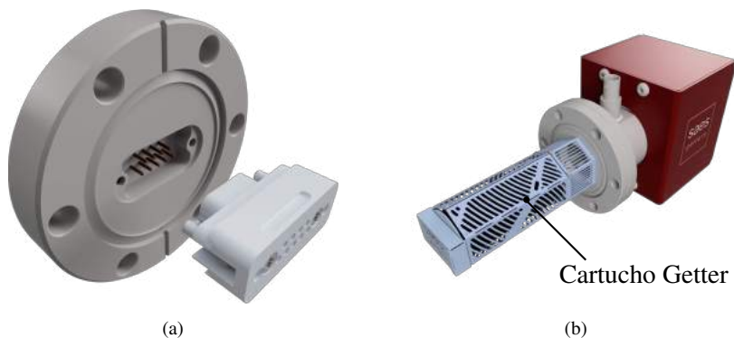
Figura 4.15. (a) Pasamuros con conector D-sub de 9 pines y correspondiente conector hembra D-sub de MACOR® para el lado del vacío. (b) Modelo 3D de la bomba NEX Torr® Z 200 (combinación NEG - iónica), la cual colocaremos en brida de doble cara.
