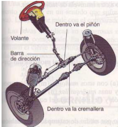
Figura 13.15. Caja de dirección de un automóvil (esquema).
