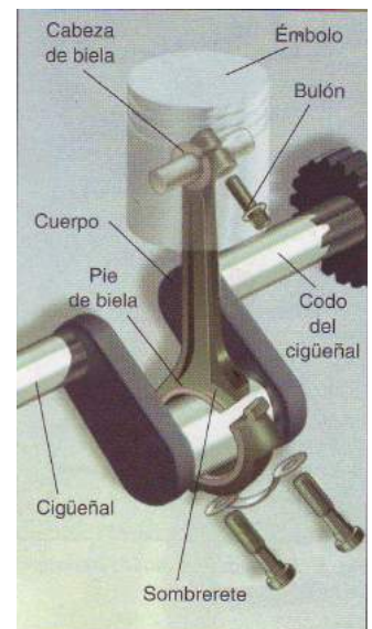
Fig. 7. Esquema del funcionamiento del mecanismo biela-cigüeñal en un motor de combustión.
