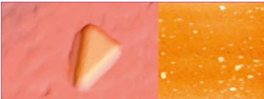
► Figura 3. Superficie de titanio con fibrinógeno adherido, obtenido con microscopia de fuerza atómica y por SEM.
