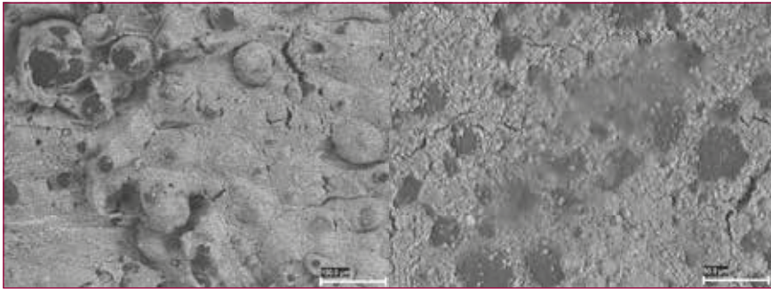
► Figura 4. Superficie de cemento PMMA con HA al 20%, y con células madre mesenquimales adheridas.
