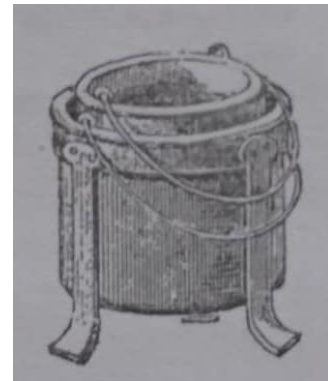
Figura 103 – Caldeira do grude ou da cola. Imagem do Manual do Marceneiro de José Colares (COLARES: s/d, p. 54).
