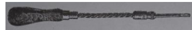
Figura 82: Chave de parafusos americana. Imagem do Manual do Marceneiro de José Colares (COLARES: s/d, p. 34).
