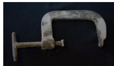
Figura 102: Grampo de ferro. Utensílio da oficina do marceneiro de Gondomar Vitorino Guimarães. Autor da imagem. Renato Castro. 2018.
