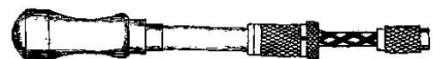
Figura 80: Chave de fenda automática. Imagem do Manual do Marceneiro de Domingos Marcellini (MARCELLINI: S/D, p. 22).
