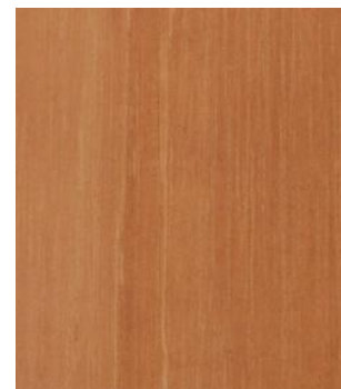
Figura 14: Pormenor da cor do cerne da madeira Cedro do Amazonas. Imagem de Brasil tropical Pisos. Disponível em:
