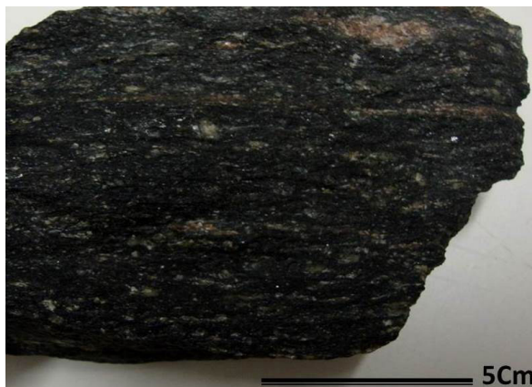
FIGURA 6 - TEXTURA MILONÍTICA DE MILONITO
