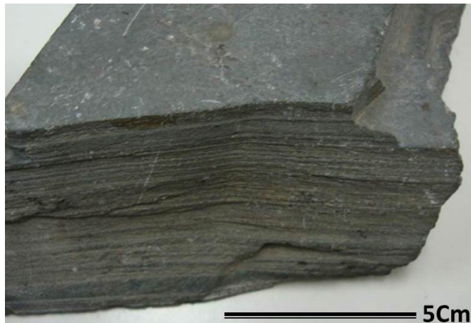
FIGURA 2 – CLIVAGEM ARDOSIANA EM AMOSTRA DE ARDÓSIA
