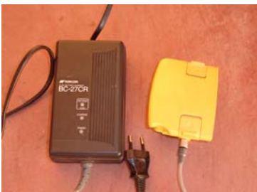
Figura 8 – Carregadores e Baterias – Topcon
