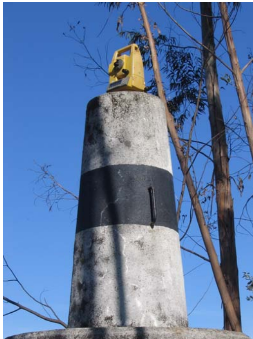
Figura 31: Marco geodésico usado para georeferenciação
