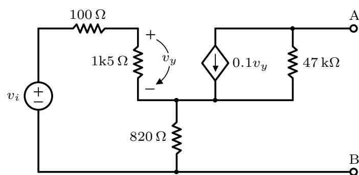
**1.5** Determine os circuitos equivalentes de Norton dos esquemas seguintes, vistos a partir do nó  $v_o$ .
