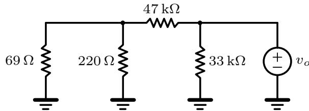
$$R_n = [(69 \parallel 220) + 47k] \parallel 33k \simeq 19k40\Omega$$
