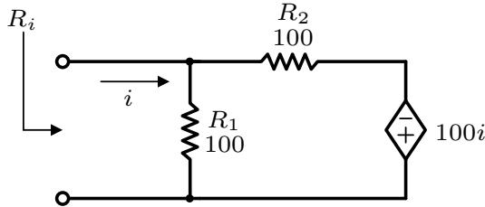
**2.2** O circuito da figura representa o esquema equivalente de um amplificador. Determine a resistência de entrada  $R_i = v_i/i_i$ .
