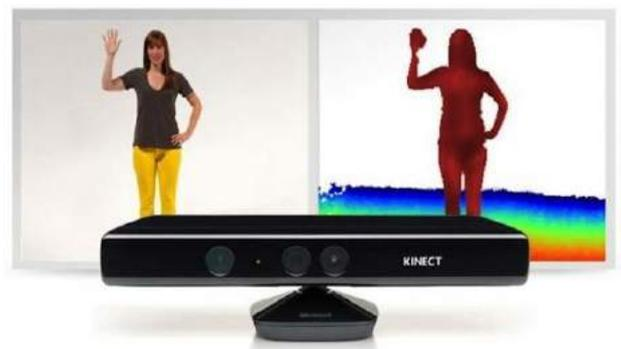
Imagen 16: Captura de movimiento con Kinect
