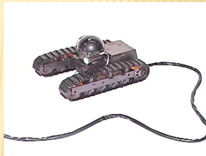
Robô inspeção de ar-condicionado
