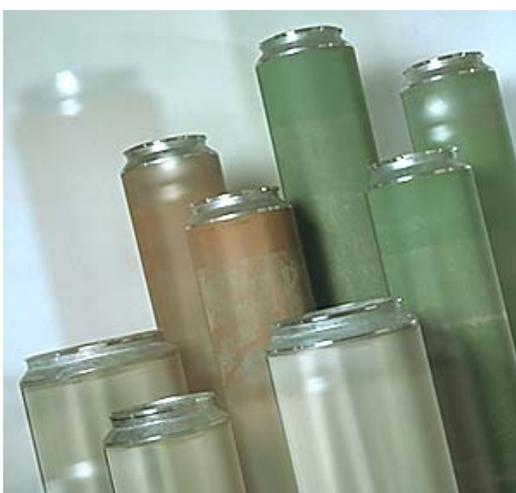
Cilindro é uma folha de tela metálica, que tem a propriedade de ser perfurada fotograficamente de acordo com o desenho a ser gravado e utiliza anéis de metal nas extremidades. Cada um dos cilindros corresponde a diferentes cores do desenho, formando as mais lindas e inúmeras padronagens que conhecemos.
