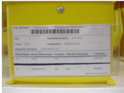
Figura 3.20 Mica remachada al contenedor de plástico
