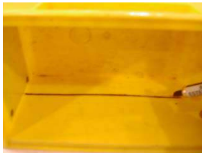
Figura 3.16 Marcado con plumón después del cautín
