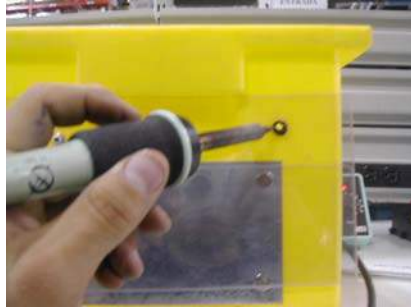
Figura 3.19 Perforación del contenedor
