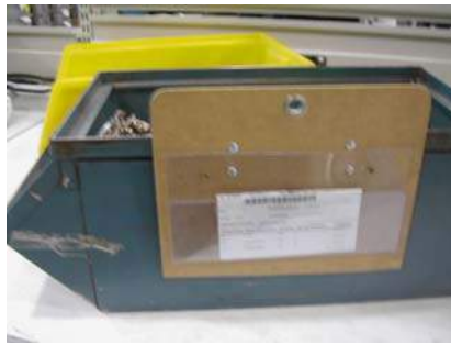
Figura 3.21 Mica remachada a la tabla con pinza
