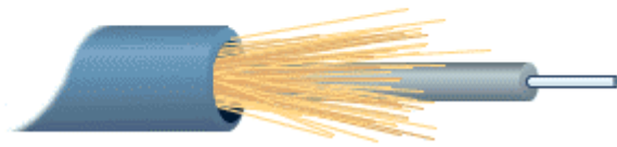
Cable de fibra óptica
