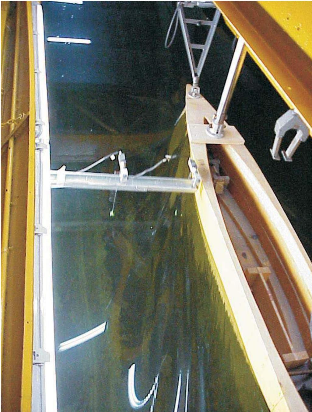
Figura 6.1: Probetas de medición de secciones longitudinales del tren de olas.
