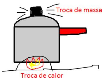
**Figura 7:** panela de pressão, exemplo de sistema aberto.
