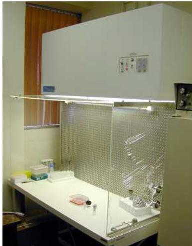
esterilizado mediante un filtro que retiene los microorganismos y es impulsado desde la parte posterior a la anterior creando un flujo laminar.
