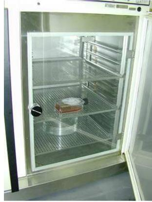
**Incubadores para el cultivo de células *in vitro*.** Obsérvese en la imagen de la izquierda la conexión a dos balas de CO<sub>2</sub>, necesarias para mantener una atmosfera con un 5% de este gas, esencial para el mantenimiento del pH del medio de cultivo. La imagen de la derecha muestra uno de los incubadores abierto.
