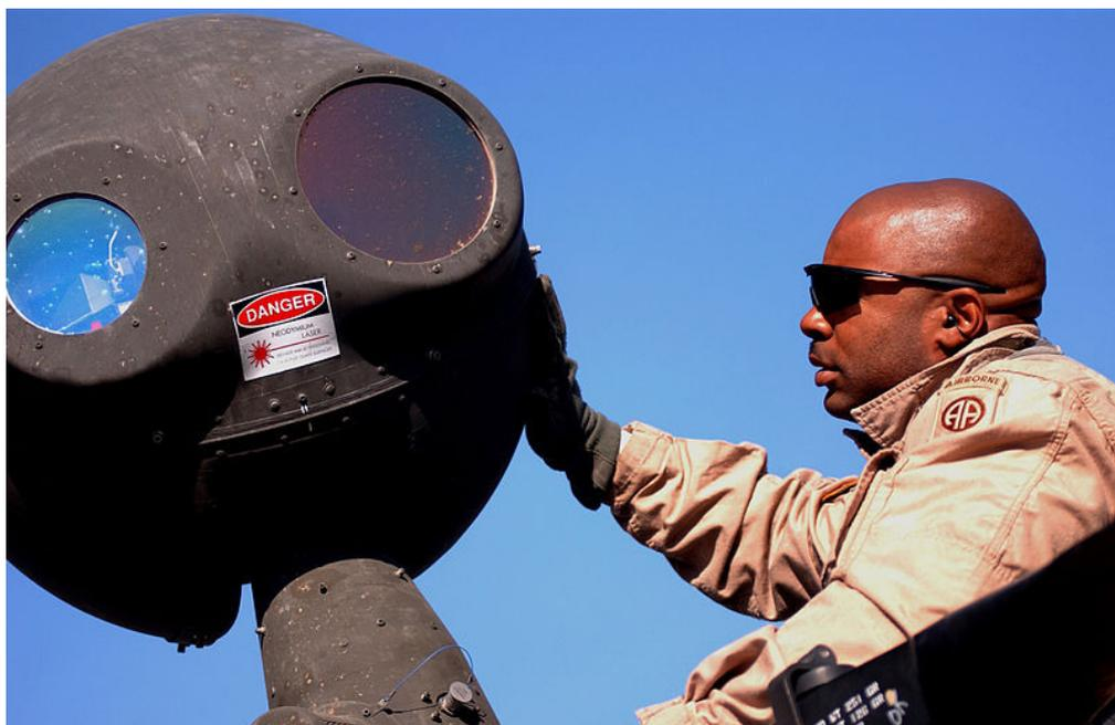
Figura 3: Inspección de un sensor térmico montado en un helicóptero OH-58D Kiowa Warrior.
