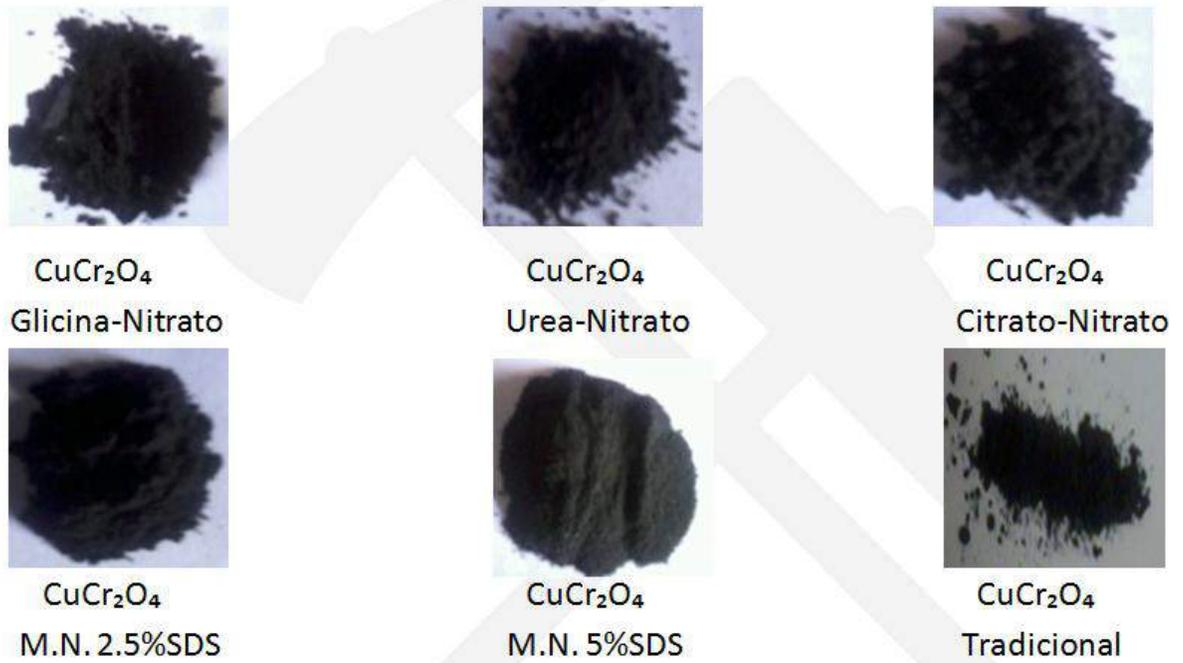
**Figura 20.** Imágenes de los polvos sintetizados estructura cristalina espinela  $\text{CuCr}_2\text{O}_4$
