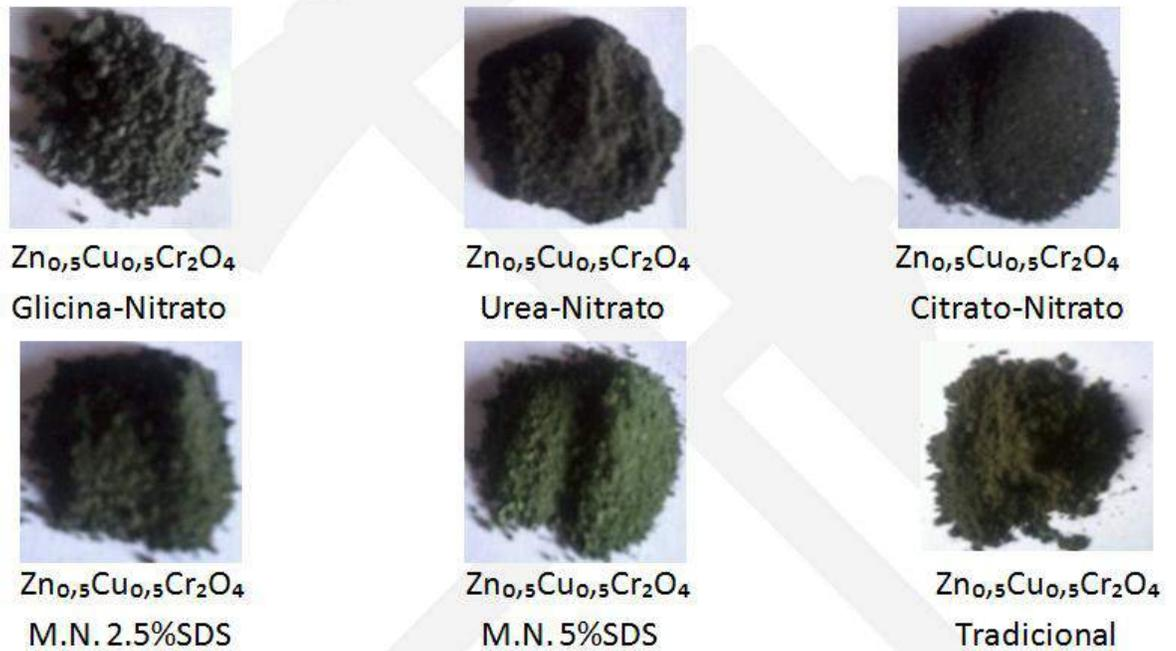
**Figura 21.** Imágenes de los polvos sintetizados estructura cristalina espinela  $\text{Zn}_{0,5}\text{Cu}_{0,5}\text{Cr}_2\text{O}_4$
