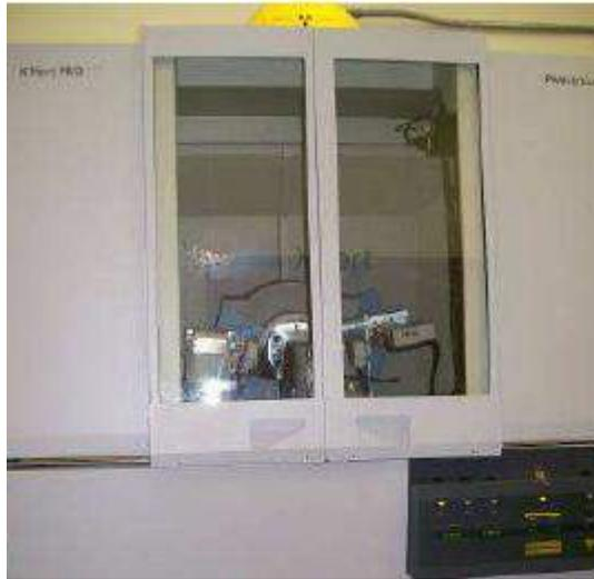
**Figura 16.** Equipo de Difracción de Rayos X
