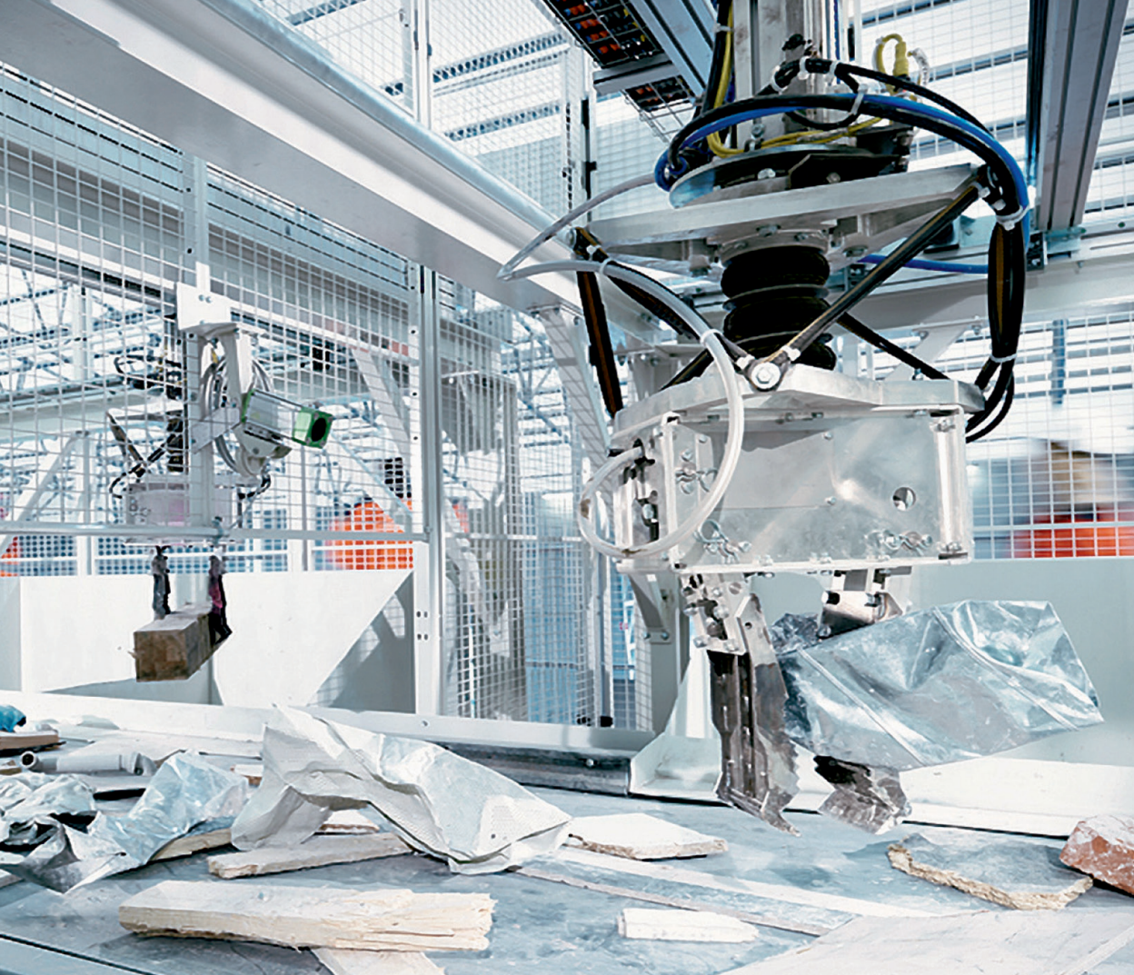
El sistema de reciclaje de ZenRobotics utiliza robots con capacidad de autoaprendizaje para clasificar materiales de un flujo de residuos. Foto: Beckhoff.
