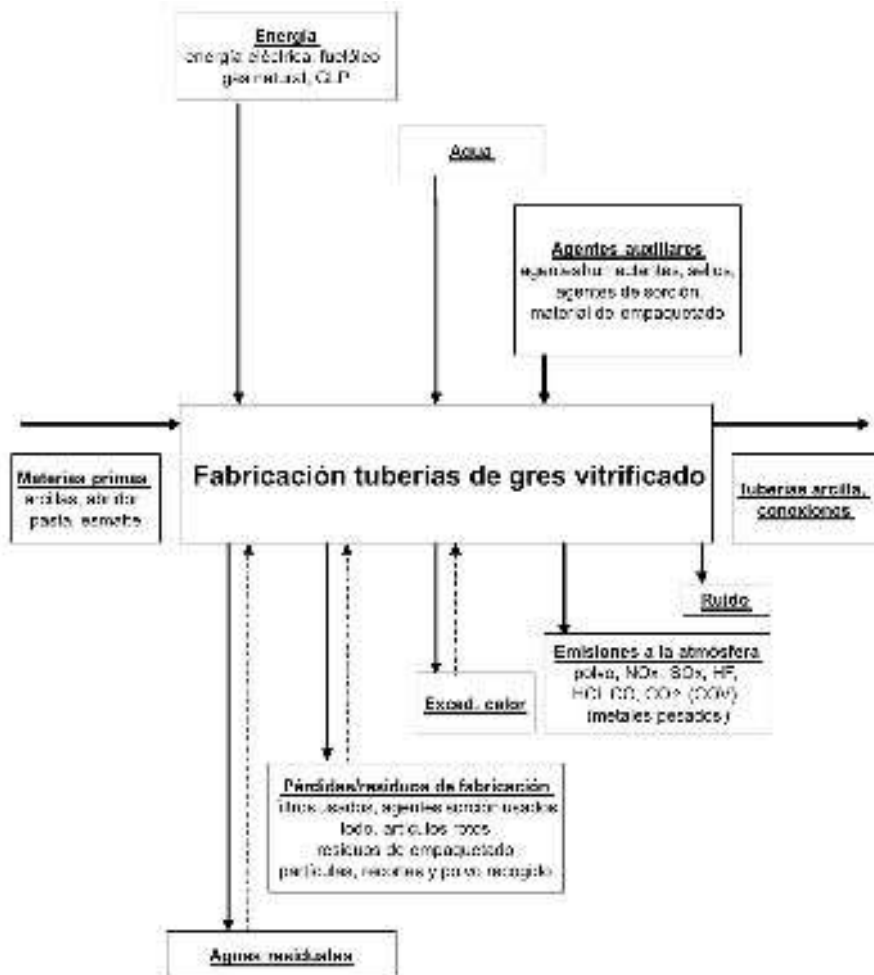
Figura 2.15. Flujos de entrada y salida en la fabricación de tuberías de gres vitrificado
