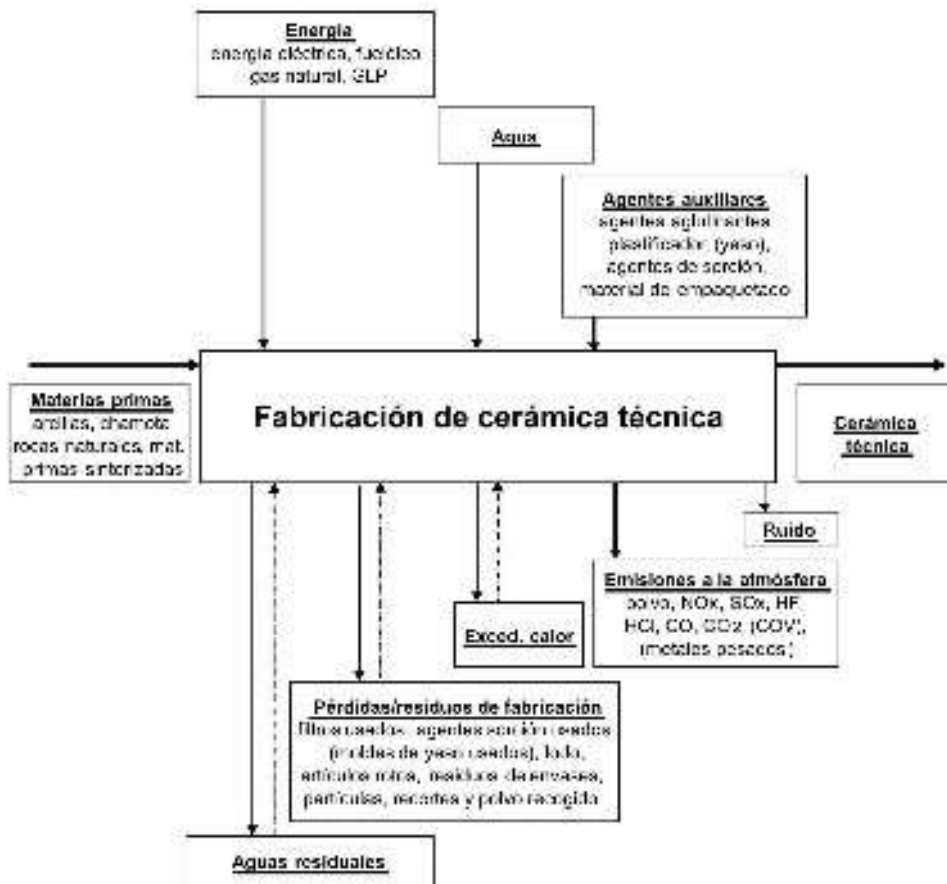
Figura 2.29. Flujos de entrada y salida en la fabricación de cerámica técnica
