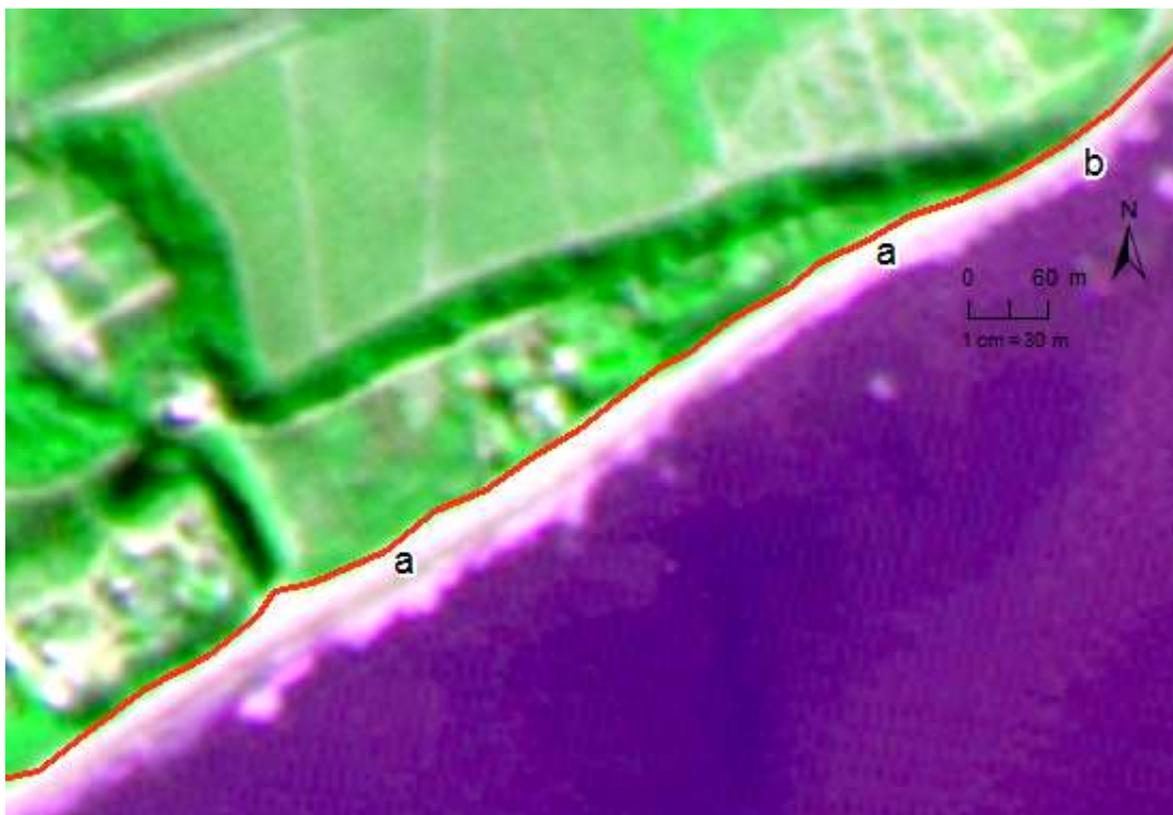
**Figura 3.3.** Captura de parte da tela do SIG destacando o procedimento de vetorização realizado - linha na cor vermelha em 2019 - com base nos limites das feições costeiras presentes: a) vegetação e faixa de areia, b) falésia ativa e faixa de areia.
