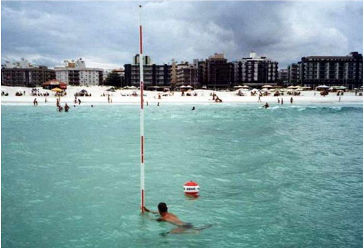
**Figura 2.17.** Extensão do perfil topográfico para a antepraia. A profundidade medida no local pelo topógrafo localizado na praia, pode ser empregada para calibrar o ecobatímetro no caso de estender o perfil por meio de embarcação.
