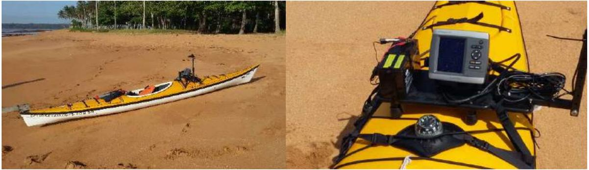
**Figura 2.19.** Caiaque com ecobatímetro acoplado com GPS.
