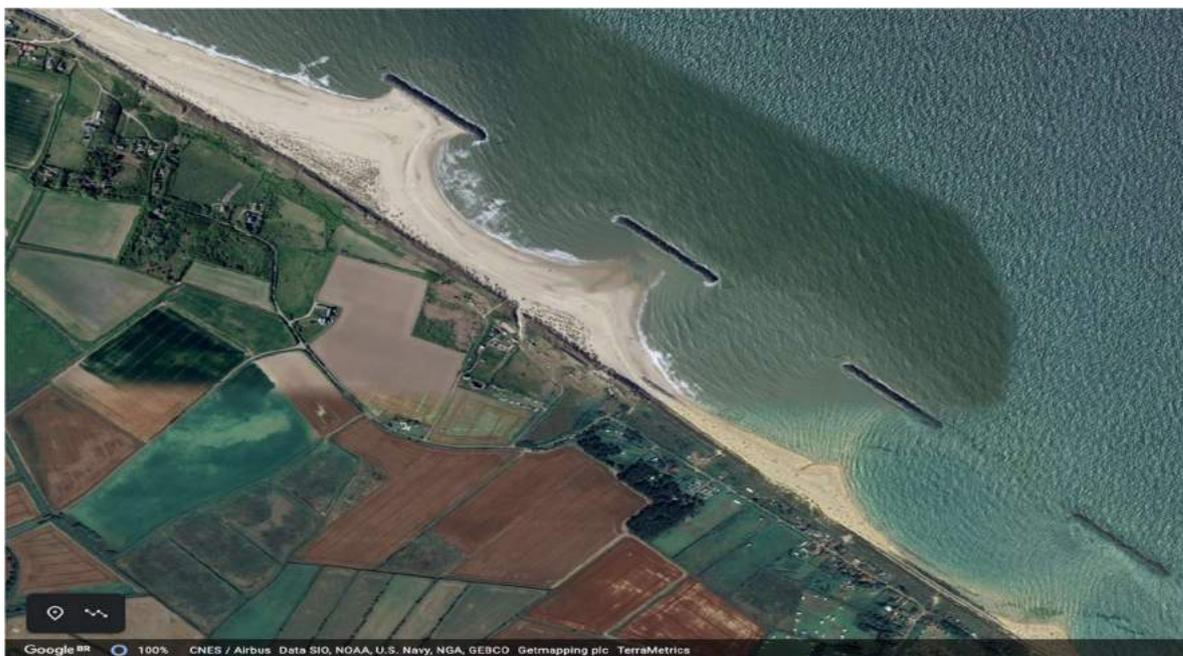
**Figura 29.10.** Quebramares destacados e segmentados na costa de Sea Palling, Norfolk, UK.
