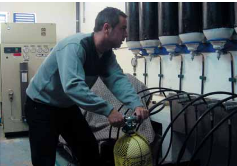
Un técnico llenará con un compresor las botellas de aire a presión.
