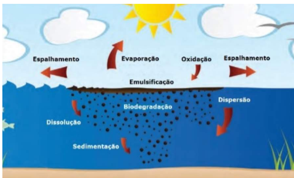
Fig. 2.62 - Processos de intemperismo de óleos em ambiente marinho (adaptado de ITOPI). (Fonte: https://www.marinha.mil.br/combate-ao-oleo/informacoes-sobre-o-oleo . Acesso 24 de junho de 2021)
