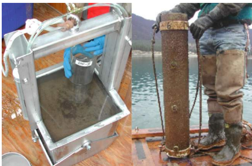
Fig. 2.11 - Exemplos de instrumentos oceanográficos usados para coletar testemunhos de sedimentos. A esquerda um box corer e a direita um tubo de PVC. (Fonte: BENT HICA LLC).
