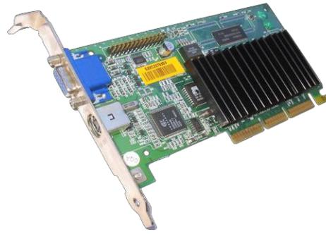
Já em computadores bons e mais sofisticados, o adaptador de vídeo pode ter um **processador próprio, o GPU ou acelerador gráfico**. Trata-se de um processador capaz de gerar imagens e efeitos visuais tridimensionais, e acelerar os bidimensionais, aliviando o trabalho do processador principal e gerando um resultado final melhor e mais rápido.
