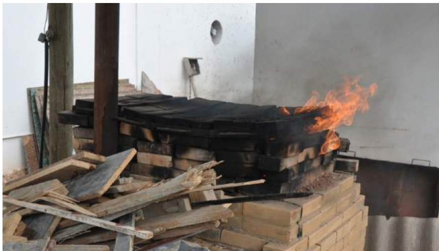
Figura 19 - É possível visualizar que o forno está bem quente, pois começa a soltar labaredas (uma chama em grandes proporções) por cima do forno. Isso indica que a queima já está quase no fim.
