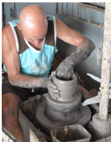
Figura 75 - Ao lado do torno, ficam duas espécies de régua, pois quando são feitas muitas peças sob encomenda e todas devem ser iguais, é preciso usar uma medida.
