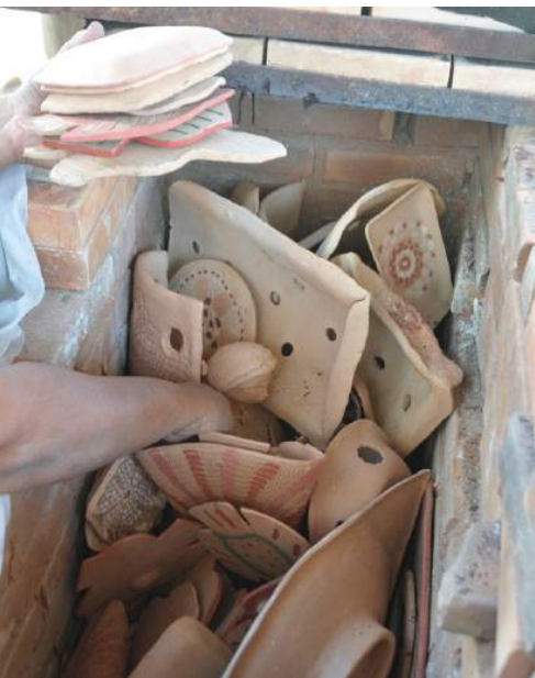
Figura 21 – As peças só poderão ser retiradas do local após em média 12 horas. Enquanto isso, o forno permanece tampado. Após esse período, o forno é destampado e, então retiram-se as peças queimadas.
