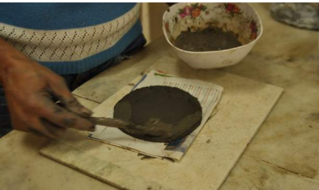
Figura 41 - Quando essa massa, que será a base do vaso, estiver riscada, então se passa a barbotina (o barro um pouco mais mole) que funciona como uma espécie de cola para colocar as “cobrinhas” em cima. No momento que se começa montar o vaso, a artesã coloca a base sobre um pedaço de papel, pois assim será mais fácil manusear a peça.
