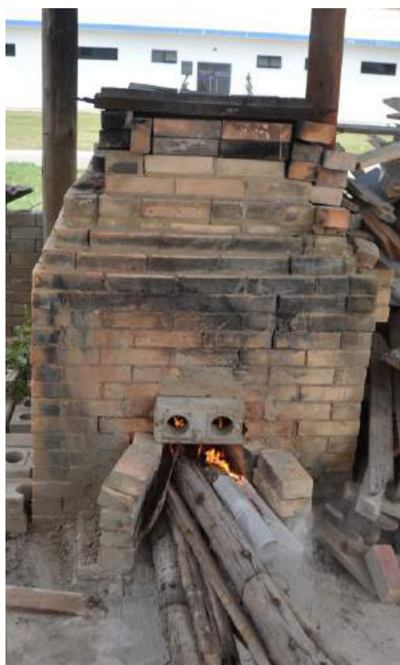
Figura 16 – A lenha é colocada bem no início do forno e então ele é acendido. É importante que a lenha esteja bem na entrada do forno. Inicia-se o esquentar. Ele é feito por em média 4 horas, no qual a lenha é empurrada gradativamente para dentro do forno.
