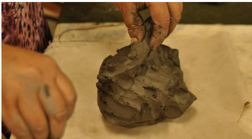
Figura 55 – O primeiro passo para a utilização do barro é a limpeza. É preciso tirar todas as impurezas que estão presas à massa para que a peça não tenha defeito ou rache desde a sua secagem até a queima.
