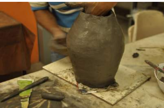
Figura 52 - Depois desse primeiro acabamento, a peça fica em repouso até chegar ao ponto de couro, isto é, quando a argila está mais dura, porém não totalmente seca, o que permite o lixamento e outros acabamentos à peça.
