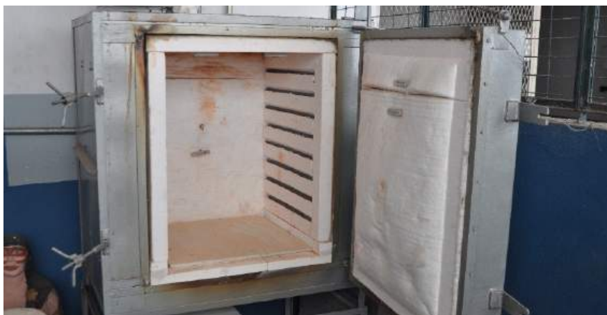
Figura 22 – O forno elétrico, como o nome já sugere, é alimentando pela energia elétrica. Ele é programado para que a queima dure cerca de 8 (oito) horas a uma temperatura de em média 800°C. As peças são arrumadas dentro do forno e então ele é ligado. Ao chegar ao fim do tempo que foi programado, o forno desliga automaticamente.
