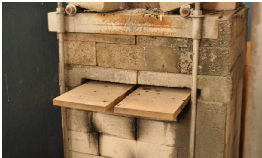
Figura 12 - Regulagem da fumaça. Com os pedaços de madeira é controlada a liberação da fumaça e, consequentemente, mantido o calor dentro do forno para que a temperatura não caia demais. Essa é uma maneira que ajuda na regulagem principalmente quando os fatores externos estão interferindo, como o vento e a temperatura ambiente muito baixa.
