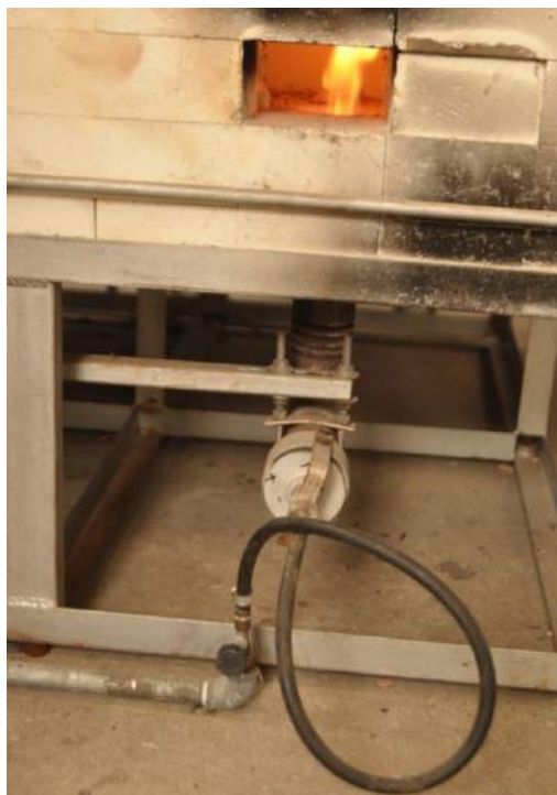
Figura 10 – Uma das mangueiras de alimentação do gás. O gás é controlado por uma válvula. Quando as quatro mangueiras estiverem ligadas, nas primeiras quatro horas em que o forno estiver aceso, ele chega a em média 400^{\circ}\text{C} . Nas seguintes quatro horas, usa-se essa válvula para que seja aumentado o fogo de cada boca, fazendo com que a temperatura aumente, chegando a no mínimo 800^{\circ}\text{C} até 1000^{\circ} . As peças ficam em queima por aproximadamente 8 horas.
