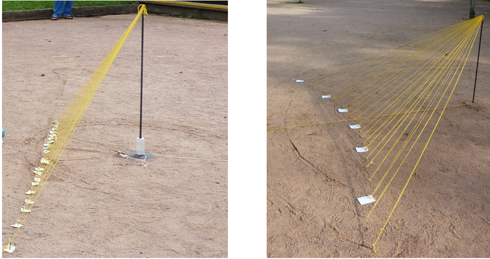
Figura 7.1: Observações com um gnômon em Porto Alegre no equinócio de outono (esquerda) e no solstício do inverno (direita). As linhas amarelas ligam a ponta do gnômon à ponta da sombra nas várias medidas. A sombra mínima dá a direção norte-sul.
