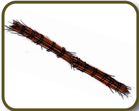
Paso 3. Construir fajinas: Hacer un rollo largo uniendo y alternando las direcciones de las ramas, el rollo debe estar atado cada 18 pulgadas
