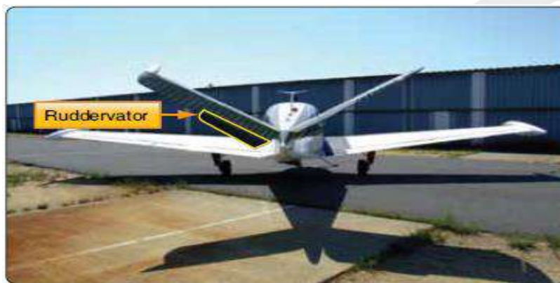
Figura 13-26 Ação dos Ruddervators
