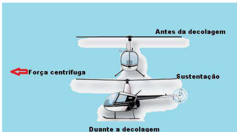
Fonte: FAA - Mechanic Training Handbook-Airframe Figura 13-41 Cone nas pás.
