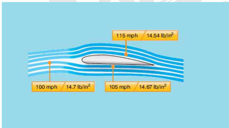
Figura 13-3 Fluxo de ar sobre a seção de uma asa.
