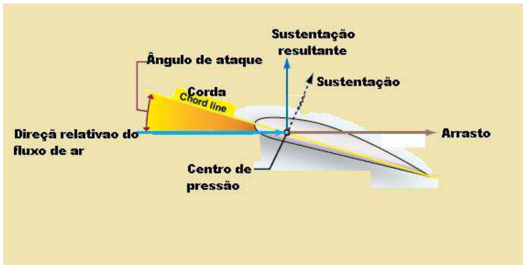
Figura 13-4 Ângulo de ataque positivo.
