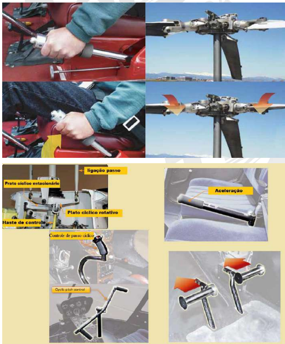
Figura 13-46 Sistema de controle de helicóptero convencional.
