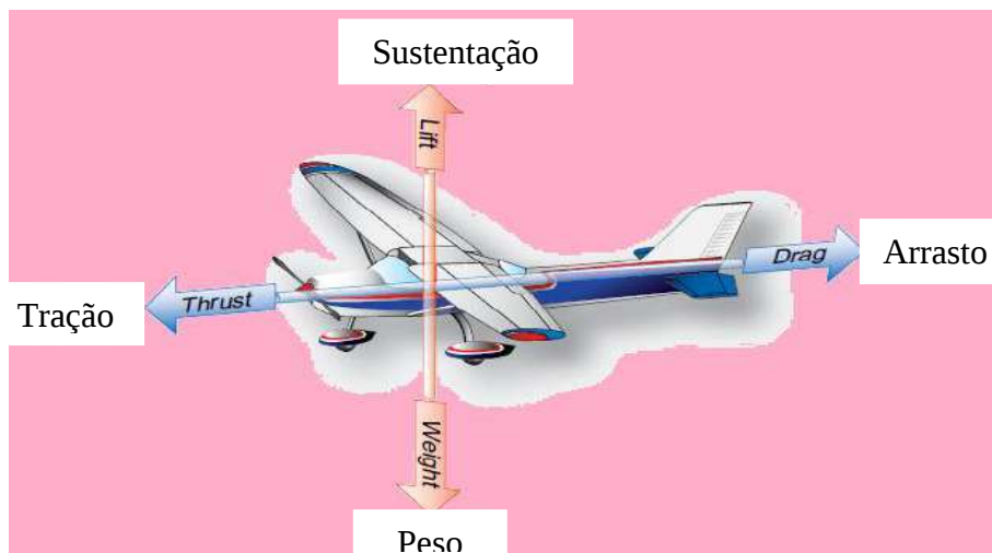
Fonte: FAA - Mechanic Training Handbook-Airframe Figura 13-7 Ação das forças em voo.
