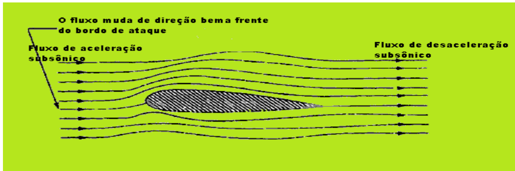
Figura 13-47 Exemplo típico de fluxo subsonico, asa subsonica.
