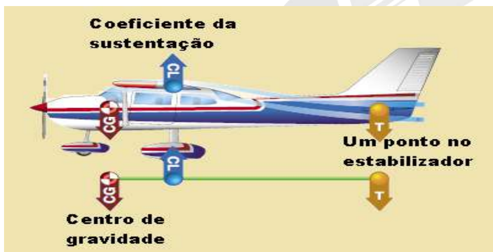
Figura 13-12 Sustentação na empenagem.
