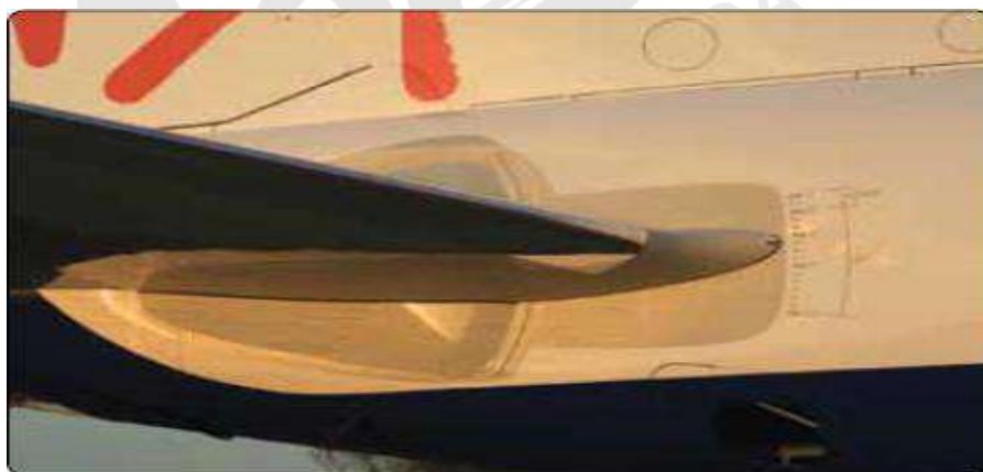
Figura 13-24 Estabilizador horizontal móvel.
