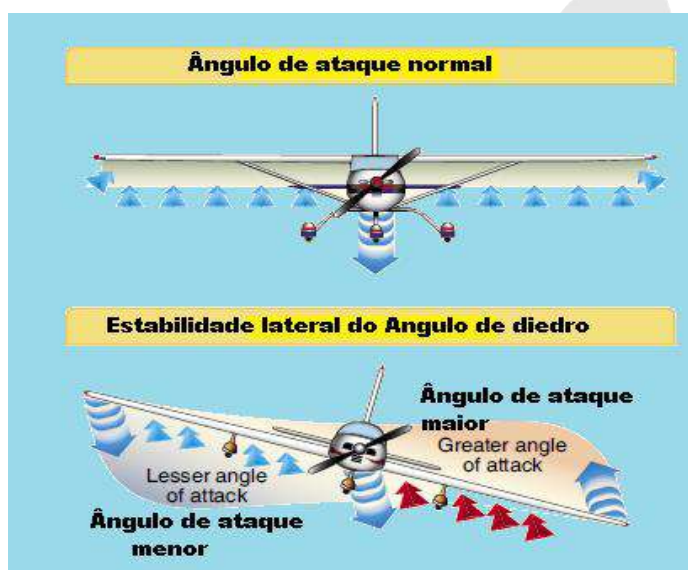
Figura 13-14 Contribuição do diedro para a estabilidade lateral.
