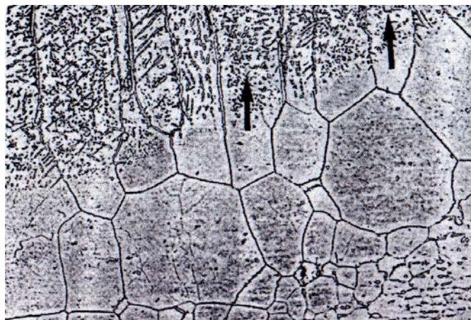
Figura 49.- Crecimiento epitaxial de granos columnares desde el metal base. Soldadura MIG de acero inoxidable (33).
