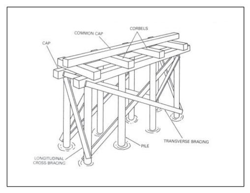
Figure 10-5. Pile-bent pier
