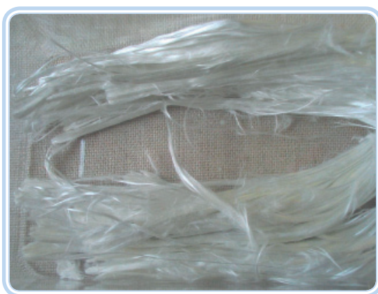
Figura 16.1: Fibras de amianto (tremolite)
