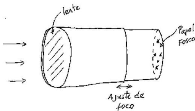
Figura 2.20: Esquema de um telescópio simples. Fonte: autor.
