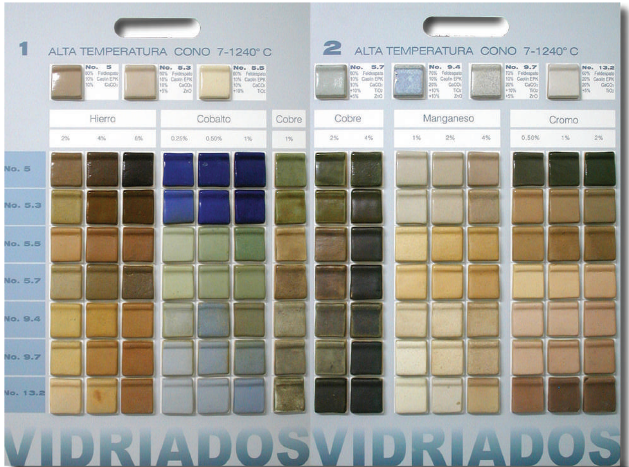
Vidriado base de alta temperatura con adiciones de óxidos colorantes
