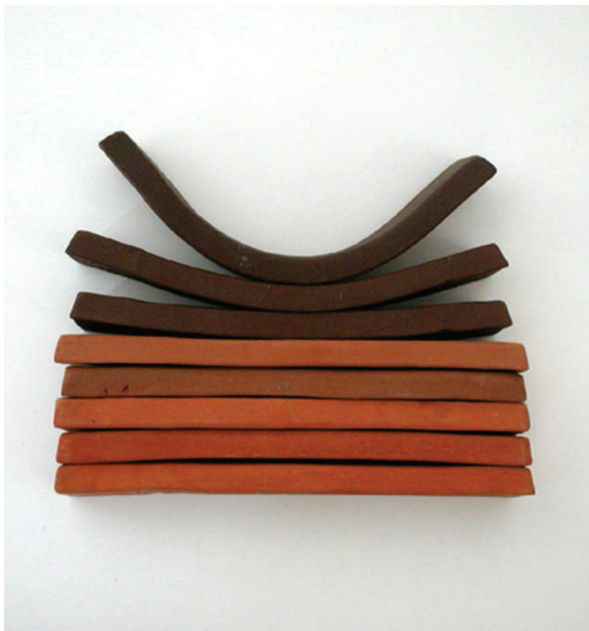
Efectos de la temperatura en una pasta de baja temperatura (Barro de Oaxaca)
