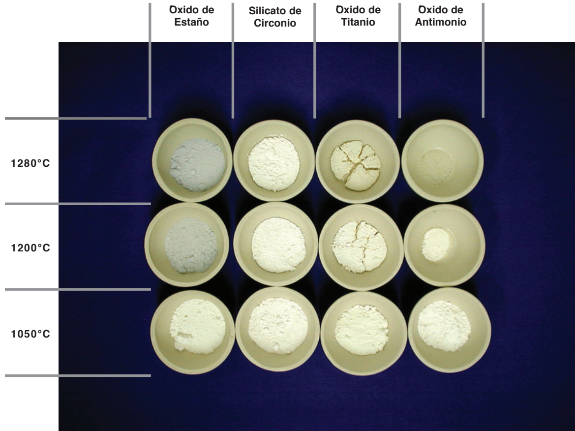
Materias primas opacificantes quemadas a diferentes temperaturas
